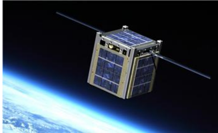
CubeSat, comme le projet PhoneSat de la Nasa, des satellites fonctionnant sous Android
